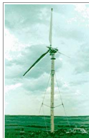
Figura 2.4 - DEBRA (Deutsch-Brasileira) 100kW, desenvolvida pelos institutos aeroespaciais do Brasil (CTA) e Alemanha (DFVLR).
