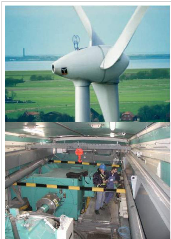
Figura 2.6 - Detalhes da nacele e interior da nacele: caixa de engrenagens e gerador.
