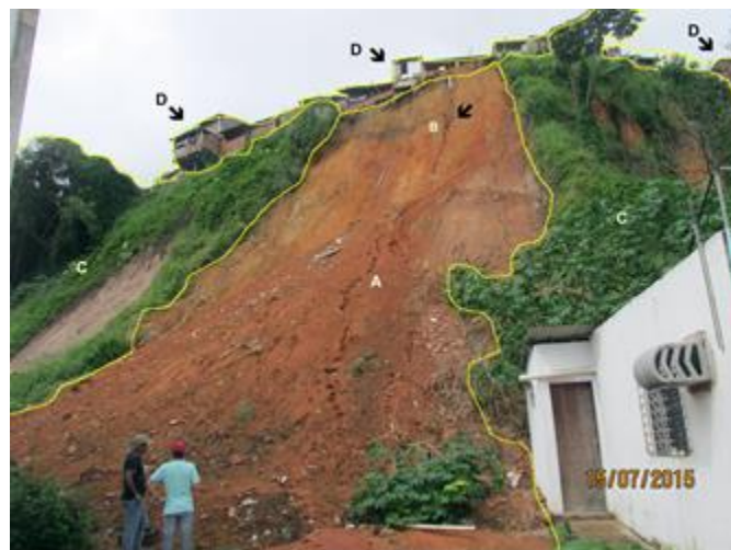
Figura 3: Registro fotográfico da área 2, destacando (A) região do escorregamento com acúmulo de solo carreado, (B) sulco erosivo causado por água servida, (C) Vegetação em estágio primário de regeneração, com predominância em gramíneas, (D) Ocupação Irregular no topo da encosta. Fonte: Autores, 2015.
